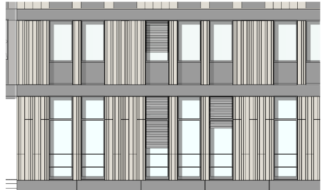
1 - Systematik Fugenbild Keramikfassade
